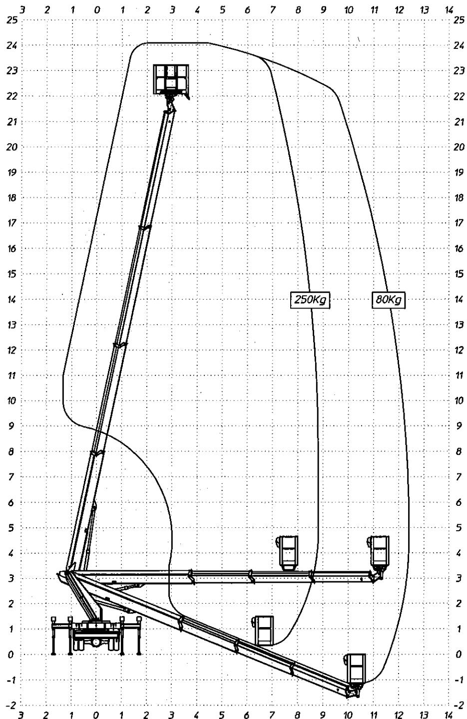
Hacchina dotata di sistema di limitazione della portée a controllo di momento, le linee del grafico rappresentano le condizioni limite, ovvero con il carico massimo (carico nominale) e con il carico minimo (peso di una persona senza attrezzi - 80kg). Per ogni carico compreso fra questi due valori si ottiene una curva che sta fra le due linee tracciate.
