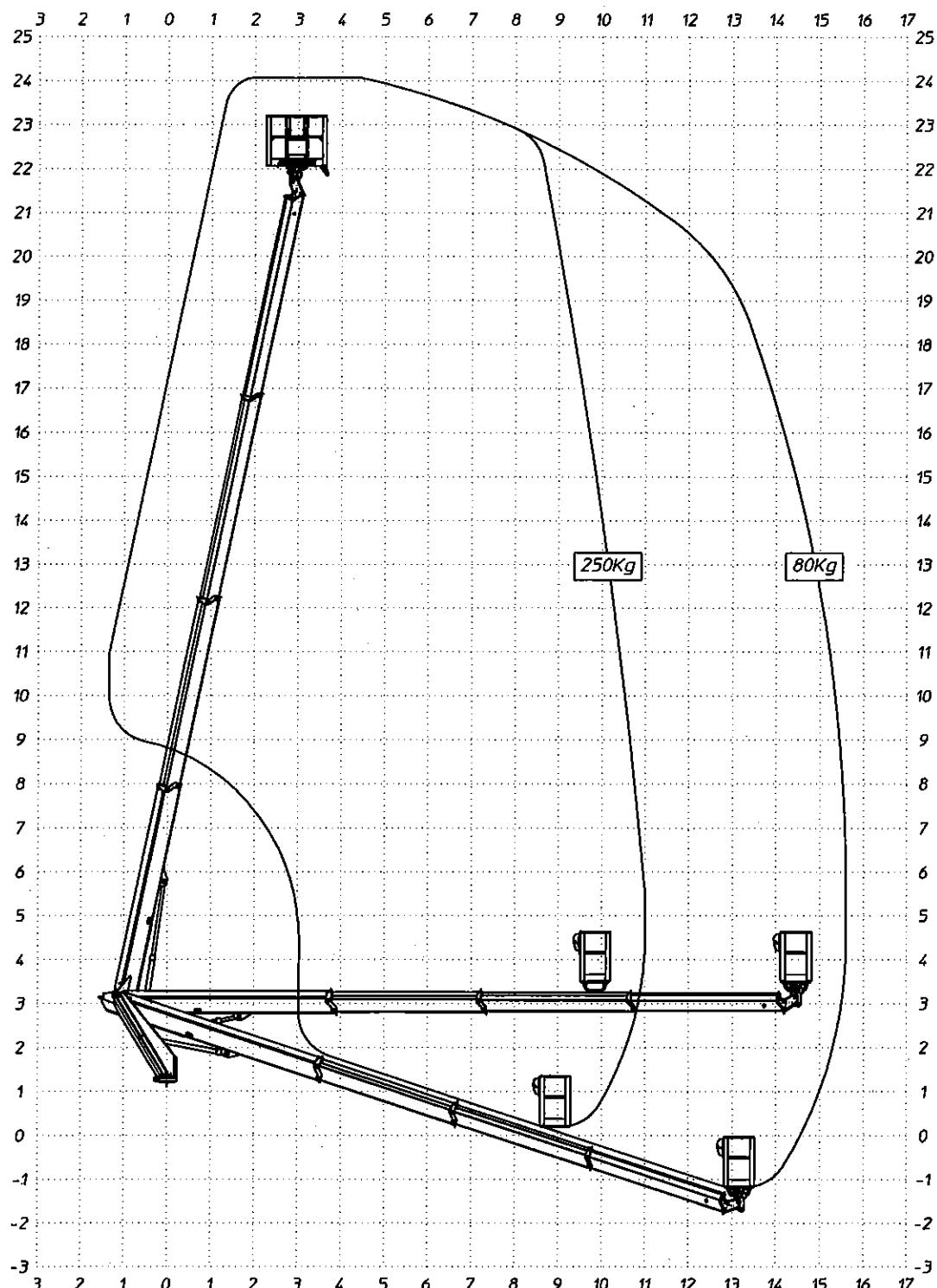
Hachette dotata di sistema di limitazione della sbarcata a controllo di momento, le linee del grafico rappresentano le condizioni limite, ovvero con il carico massimo (carico nominale) e con il carico minimo (peso di una persona senza attrezzi - 80kg). Per ogni carico compreso tra questi due valori si ottiene una curva che sta fra le due linee tracciate.
