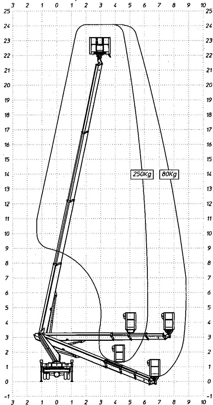
Hacchina dotata di sistema di limitazione della sbarco a controllo di momento; le linee del grafico rappresentano le condizioni limite, ovvero con il carico massimo (carico nominale) e con il carico minimo (peso di una persona senza attrezzi - 80kg). Per ogni carico compreso tra questi due valori si ottiene una curva che sta fra le due linee tracciate.
